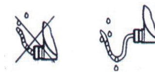
图7.3 防水接线示意图
